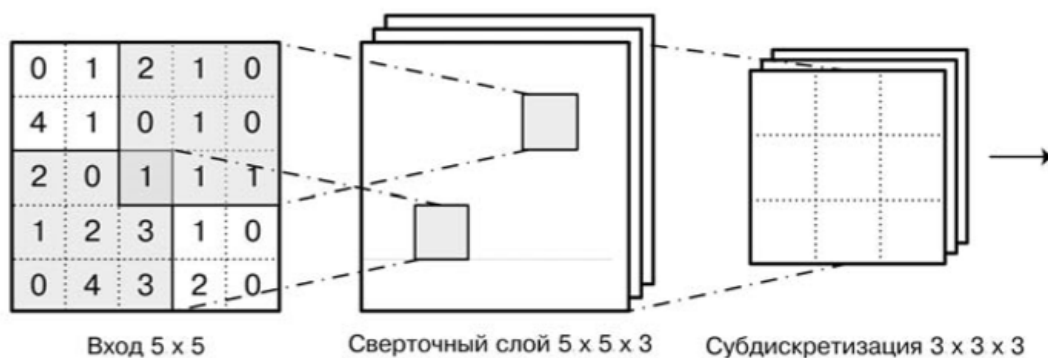
Рис. 22. Схема одного слоя сверточной сети: свертка, за которой следует субдискретизация
